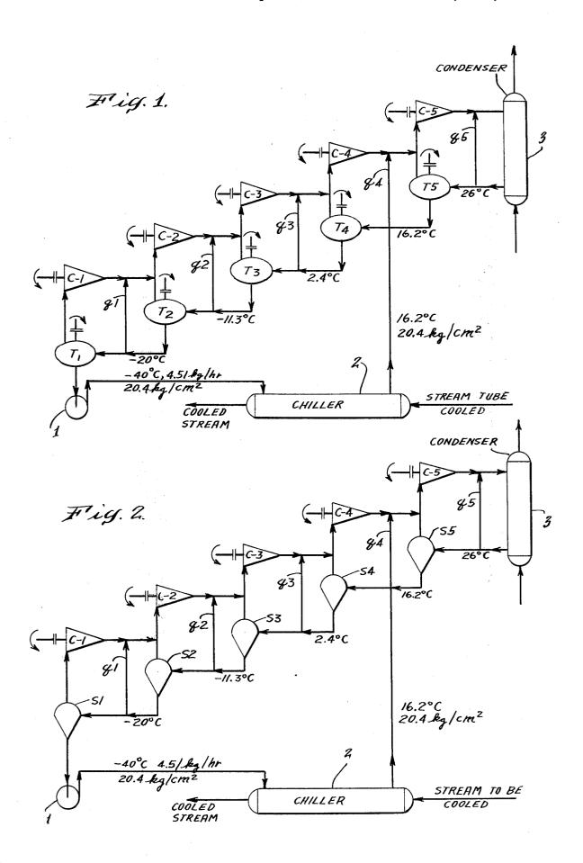
REFRIGERATION SYSTEM USING ENTHALPY CONVERTING LIQUID TURBINES
